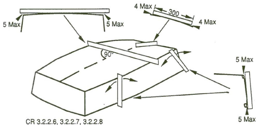
Sur les coques en GRP seulement pour l'application des présentes mesures et autres « contrôles de planéité du panneau », la surface des panneaux sera limitée sur les bords par une ligne définie avec l'outillage « standard de définition des lignes de mesure »
